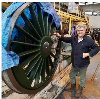
La "roue de la fortune" que Bruno semble tourner n'est qu'une des 8 roues de traction du grand vaisseau de vapeur et d'acier, la locomotive 241-P-9...
